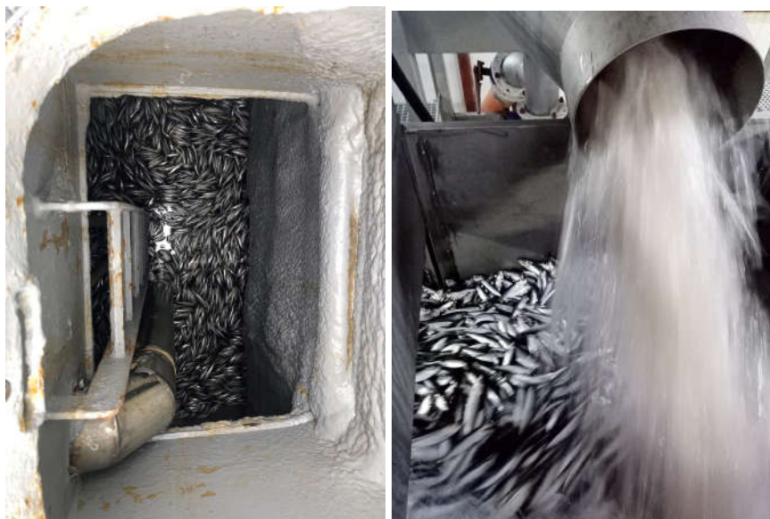
Рис. 29. Рыба в бункере судна перед выгрузкой (слева) и процесс выгрузки рыбы через рыбонасос на рыбоприемном пункте (справа)
