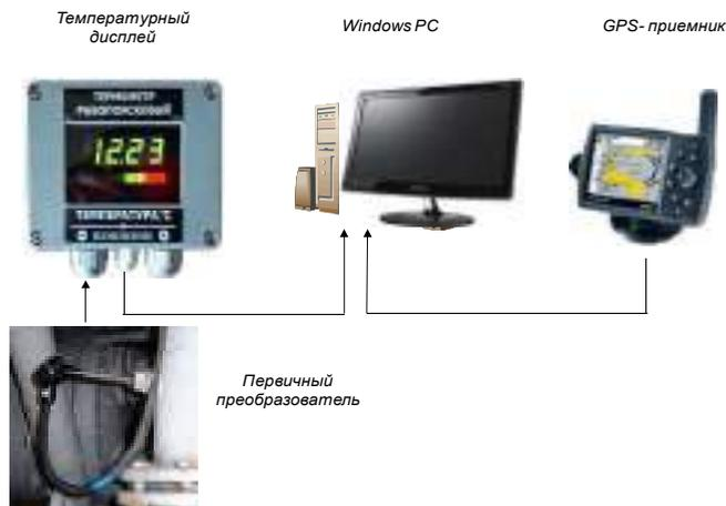
Рис. 1. Общая схема взаимосвязи блоков промыслового плоттера «ThermoTrack» [Филатов и др., 2011]
