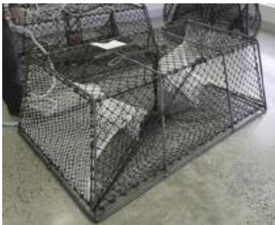
Рис. 10. Рыболовная ловушка с конусообразными входами
