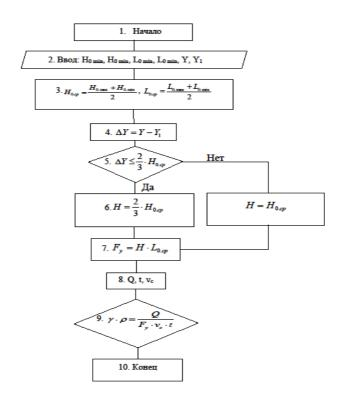
Рисунок. Блок-схема алгоритма расчета параметра уловистости трала  $\gamma \cdot \rho$  Fig. Block diagram of algorithm for calculation of trawl catching efficiency  $\gamma \cdot \rho$
